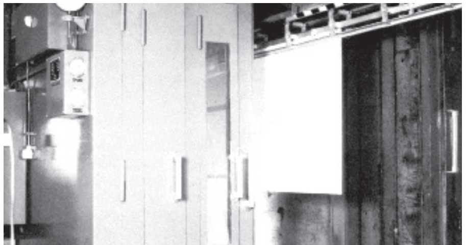
Abb. 5: Einfahren einer aufgehängten PLEXIGLAS® Platte in den Wärmeschrank
