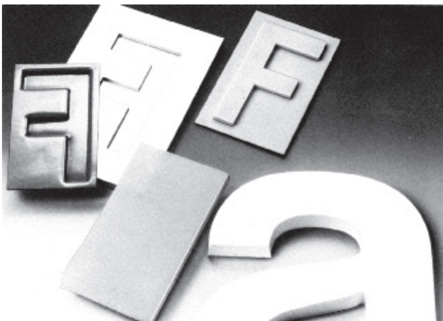
Abb. 20: Druckumgeformte Buchstaben aus PLEXIGLAS® GS mit Alu-Formwerkzeug und Silikon-gummiplatte
